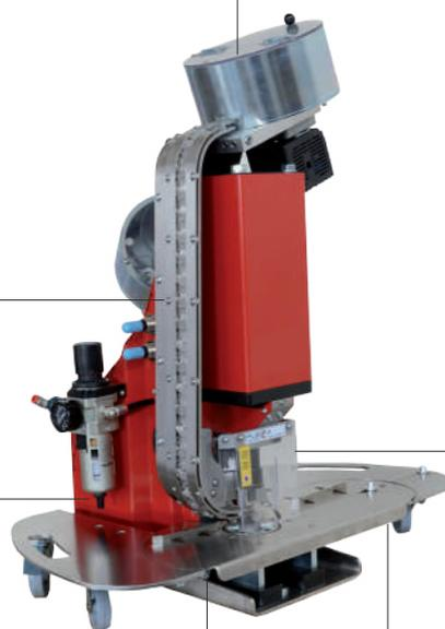
Superficie di scorrimento del materiale in acciaio inox con guide di posizionamento per regolare la distanza dal bordo del materiale e tra gli occhielli
